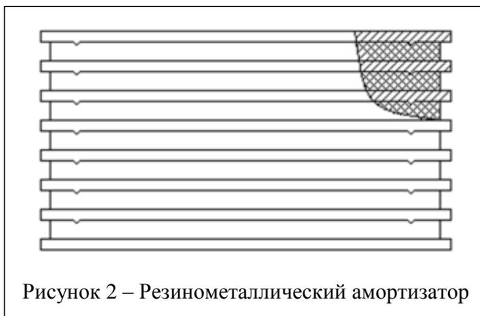
Рисунок 2 – Резинометаллический амортизатор
